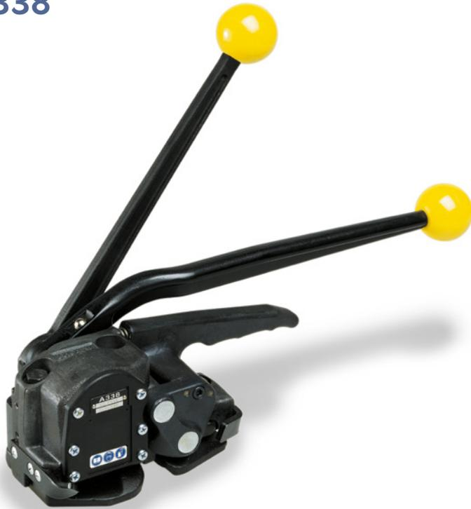
Bei dem Fromm A338 handelt es sich um ein sehr handliches Kombinationswerkzeug, welches sich zum Umreifen von flachen Verpackungen mit Normalstahlband (bis 850 N/mm<sup>2</sup>) oder Hochleistungsstahlband (bis 1100 N/mm<sup>2</sup>) hervorragend eignet. Er überzeugt durch ein spezielles Spanntriebssystem mit einer sehr hohen Bandspannung von bis zu 5500 N bei einem Kraftaufwand von nur 240 N.
